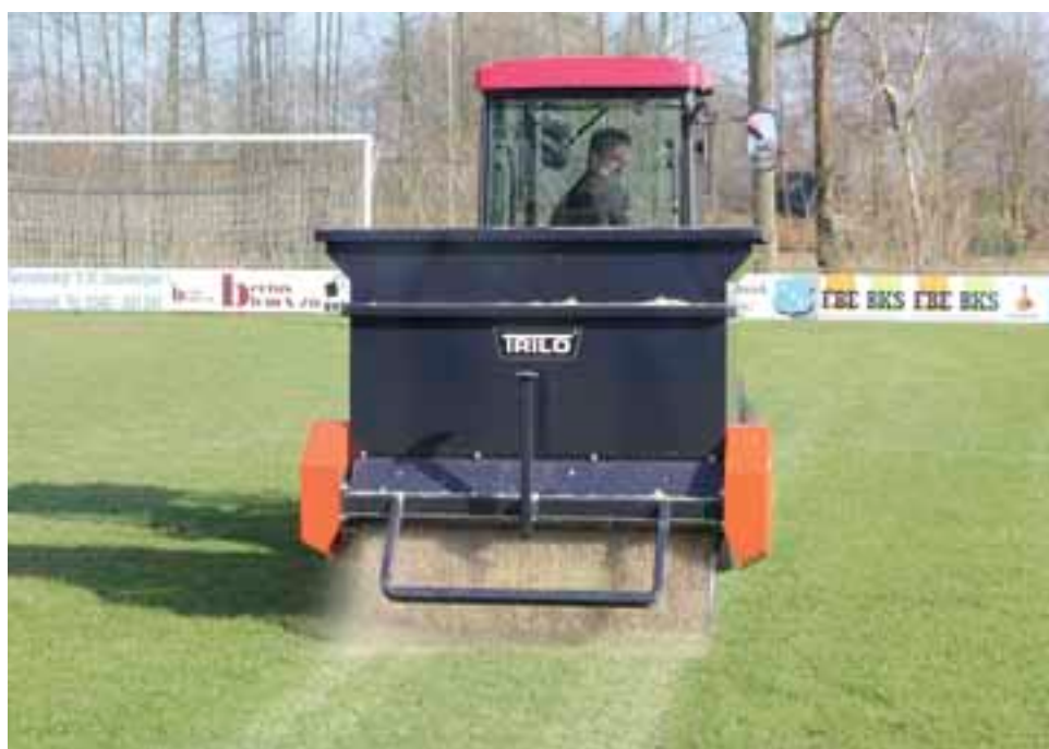
Топ-дрессинг/пескование с помощью TriloFlexispread FS 1500
